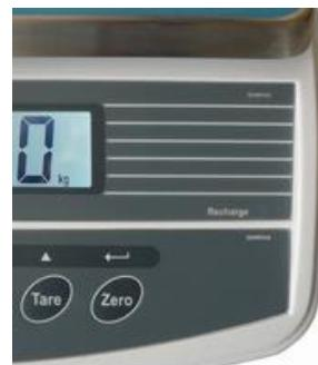
Jestliže váha bude používána bez řádného dobíjení, na displeji se ukáže kontrolka symbolu „BATERIE“. Váha bude pracovat ještě po dobu cca 10 hodin a poté se automaticky vypne. Prosím dobíjejte akumulátor včas nebo váha nebude fungovat. K dobití akumulátoru připojte k váze přiložený adapter. Dobití na plnou kapacitu trvá cca 12 hodin. Váha má provoz na akumulátor cca 90 hodin.
