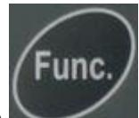
Návrat do normálního režimu vážení provedete tlačítkem .
