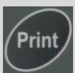
Odešle údaje do PC nebo na tiskárnu přes RS232, Pokud není nastavena funkce automatického sčítání, tak se klávesou přidávají hodnoty do paměti.
